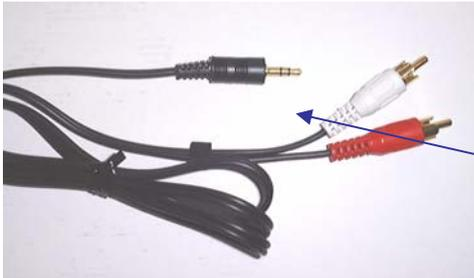
\* RCA 変換コードの赤いプラグをアンプの赤いジャックに、また白いプラグをアンプの白いジャックに接続します。
